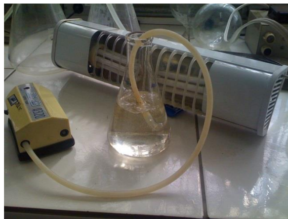
FIGURA 11: APARATO MONTADO PARA A ECLOSÃO DOS CISTOS DE A. salina .
