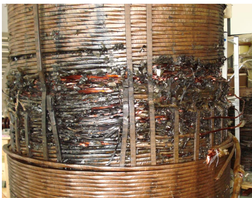
Figura 13. Imagem de pirólise do papel isolante causada por falhas no transformador [45].
