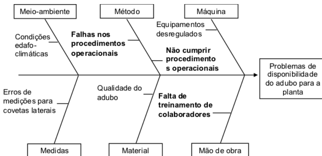
FIGURA 35 - DIAGRAMA DE ISHIKAWA PARA PROBLEMAS DE DISPONIBILIDADE DO ADUBO PARA A PLANTA
