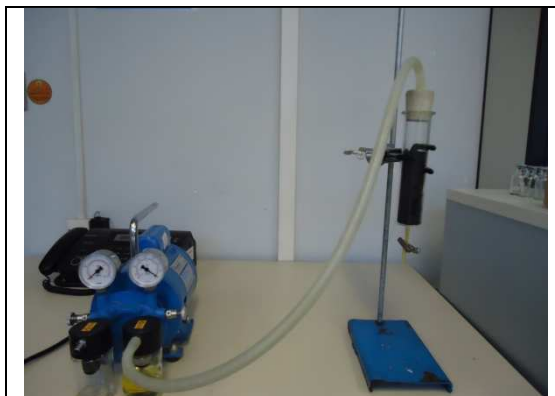
FIGURA 42 - APARATO MONTADO PARA DETERMINAÇÃO DA POROSIDADE DO LEITO FONTE : LACAUT / UFPR
