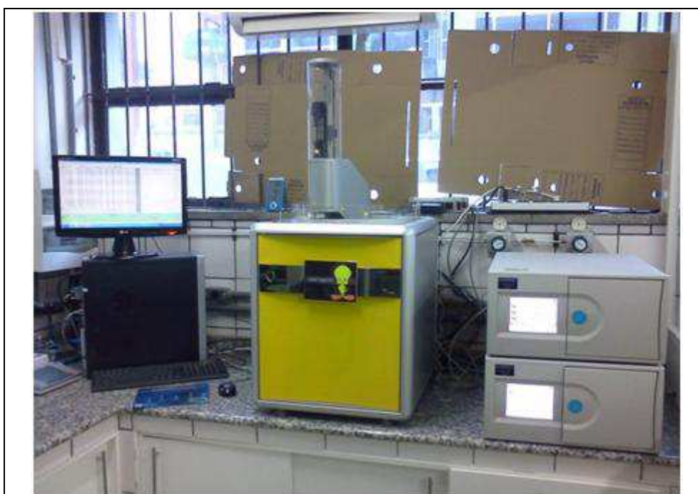
FIGURA 14 - ANALISADOR DE ENXOFRE E NITROGÊNIO ELEMENTAR TRACE SN COM DETECTOR FLUORECÊNCIA UV E DETECTOR DE QUIMILUMINESCÊNCIA FONTE: LACAUT / UFPR
