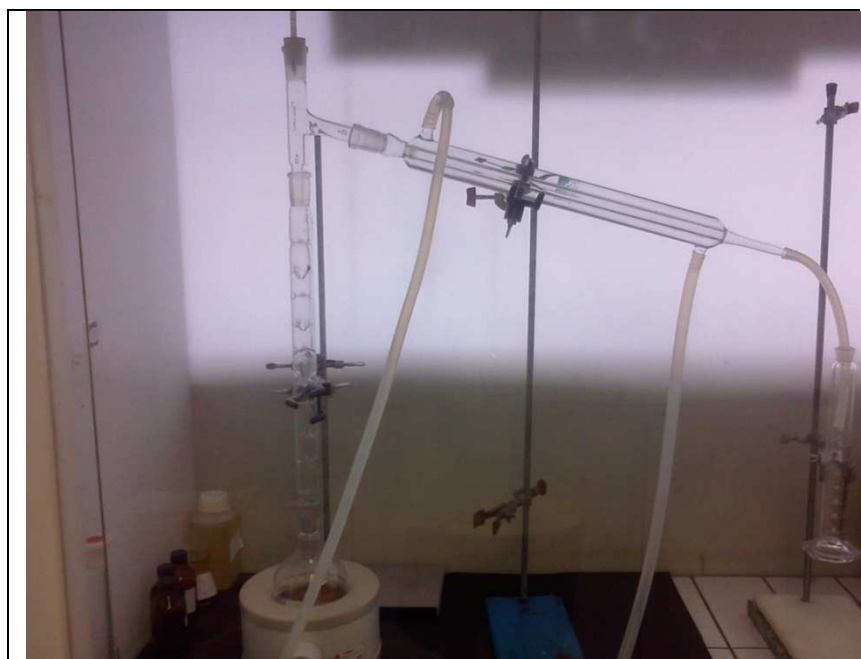
FIGURA 53 - EQUIPAMENTO DE DESTILAÇÃO FRACIONADA UTILIZADO NA RECUPERAÇÃO DO TOLUENO FONTE: LACAUT / UFPR
