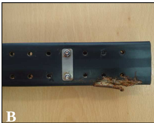
Figura 7 – (A) Colar GPS-VHF afixado em exemplar macho adulto de capivara Hydrochoerus hydrochaeris (G6); (B) Visão geral do colar com danos causados por abrasão após duas semanas de uso; (C) Aproximação sobre a região danificada.
