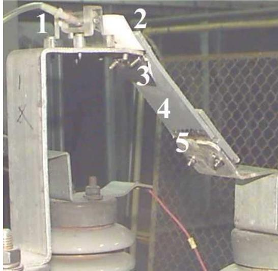
FIGURA 12 - MONTAGEM DO CORPO DE PROVA NO ENSAIO PLANO INCLINADO, EM 1 ENTRADA DA SOLUÇÃO CONTAMINANTE, 2 PAPEL UNIFORMIZADOR DO FLUXO DA SOLUÇÃO CONTAMINANTE, 3 ELETRODO DE ALTA TENSÃO, 4 AMOSTRA E 5 ELETRODO DE BAIXA TENSÃO.
