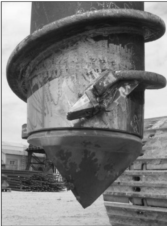
Figura 9. Broca para perfuração de fundações profundas em CUAR – Alemanha.
