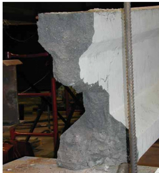
Figura 20. Viga de CUAR após ensaio de ruptura. FONTE: Graybeal, 2006.
