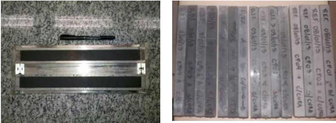
Figura 39. Molde utilizado para a confecção e corpos de prova prontos para medição.
