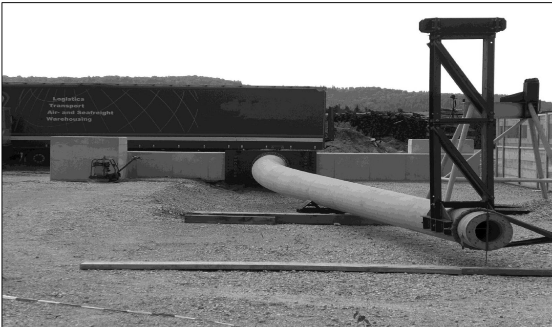
Figura 8. Teste de flexão realizado em elemento pré-moldado em CUAR – Alemanha.
