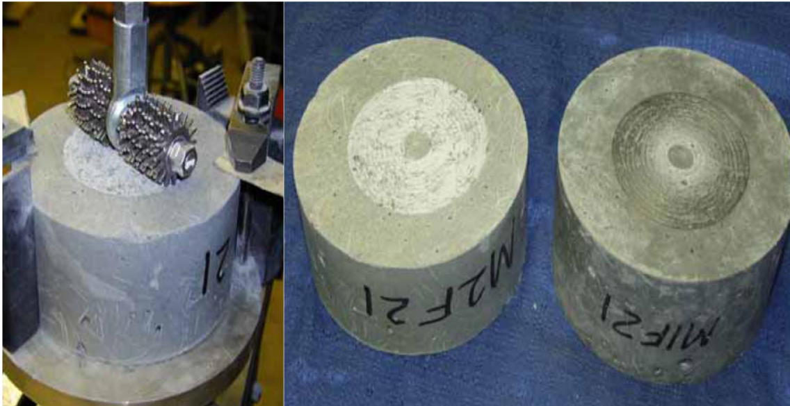
Figura 26. Realização do ensaio e resultados comparativos de abrasão.
