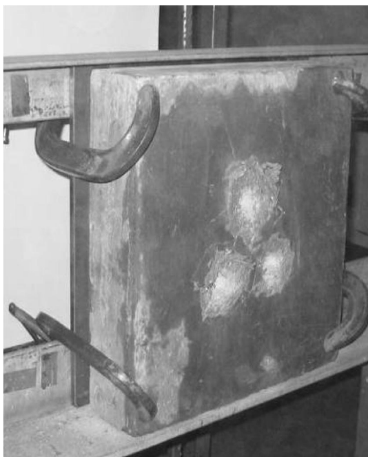
Figura 11. Placa de CUAR após ser alvejada por tiros de fuzil calibre 7.62mm.
