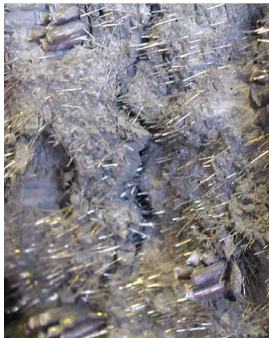
Figura 23. Fibras metálicas aparentes após ruptura de uma viga de CUAR em escala real.
