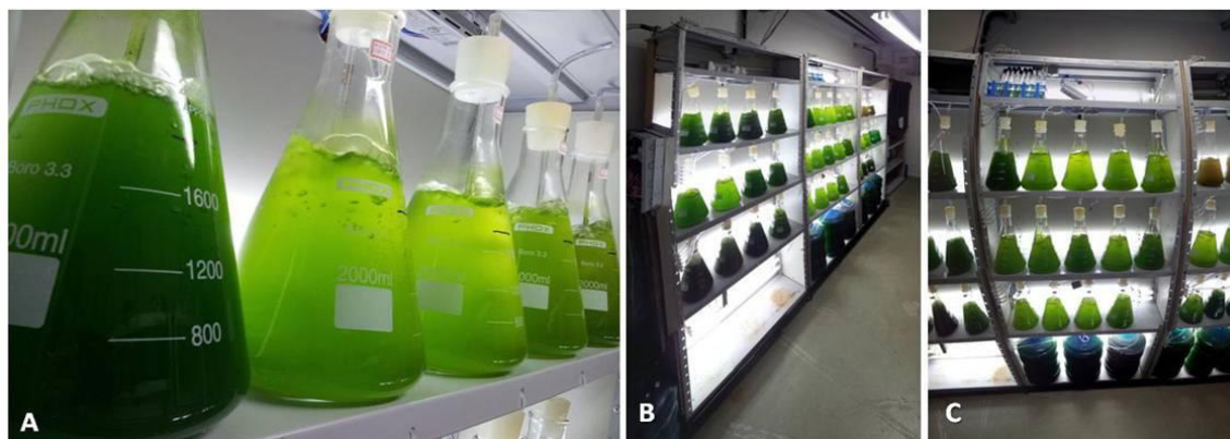
FIGURA 15 - CULTIVO DE MICROALGAS EM ESCALA LABORATORIAL: (A) FOTOBIORREADORES TIPO FRASCO ERLLENMEYER DE 2 L E (B/C) SALA DE CULTIVO CLIMATIZADA PARA CULTIVO DE MICROALGAS.
