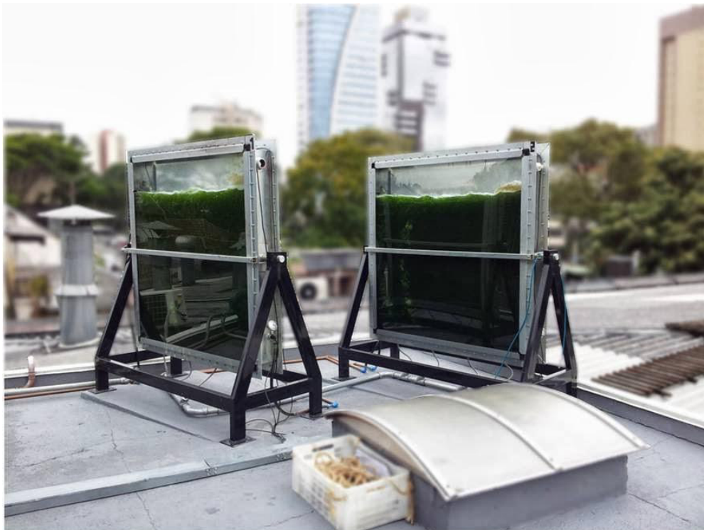
FIGURA 07: FOTOBIORREATOR DE PLACA PLANA PARA PRODUÇÃO DE MICROALGAS. FONTE: O autor (2013).
