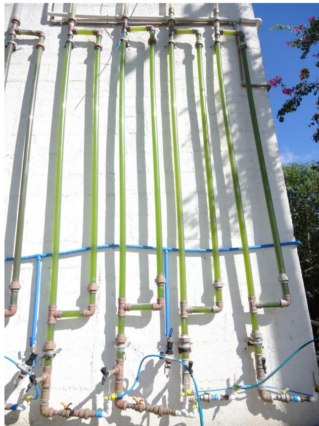
FIGURA 25 – FOTOBIORREATOR MODELO AIRLIFT DE CIRCULAÇÃO EXTERNA. FONTE: O Autor (2013).
