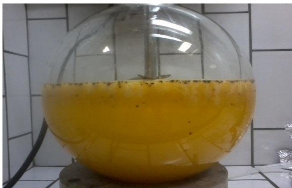
FIGURA 6. Óleo de pinhão manso antes da neutralização
