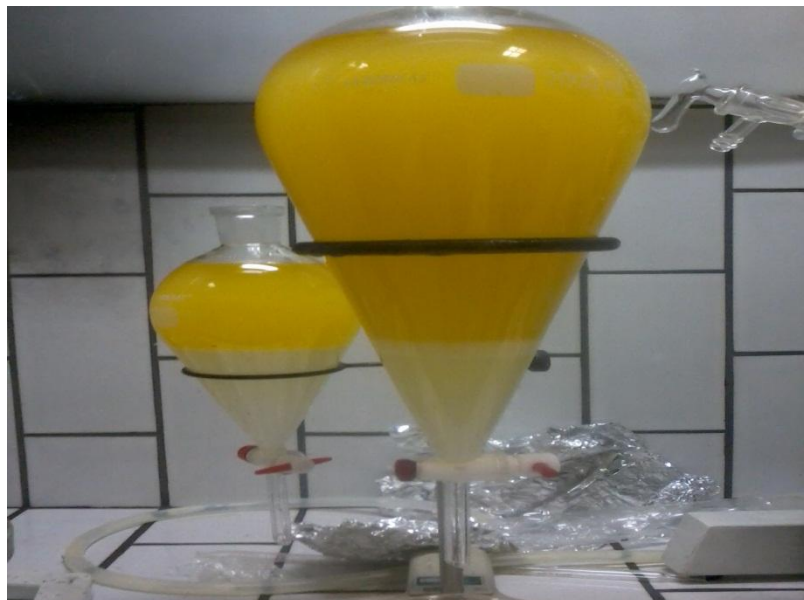
FIGURA 8. Óleo de pinhão manso neutralizado
