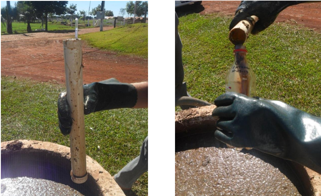
Figura 6 - Medição da densidade do afluente, e coleta da amostra de entrada de dejetos do biodigestor
