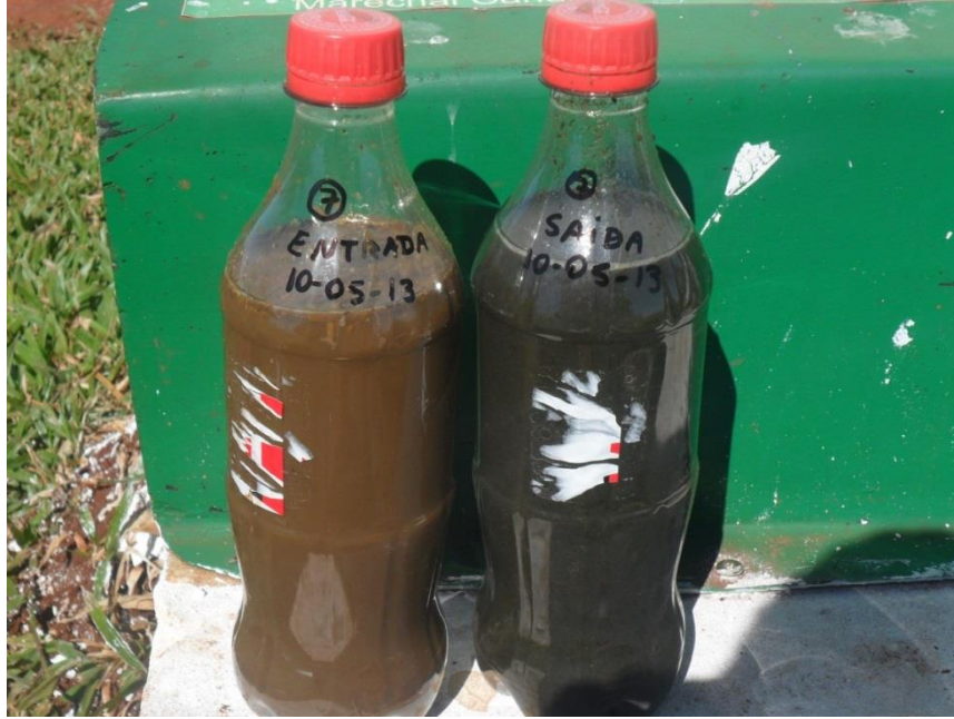
Figura 7 - Amostra de entrada e saída de dejetos do biodigestor. Fonte: UTECH (2013)
