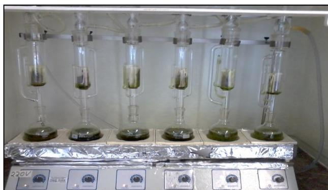
**FIGURA 14.** Conjunto soxhlet sobre uma bateria Sebelin.
