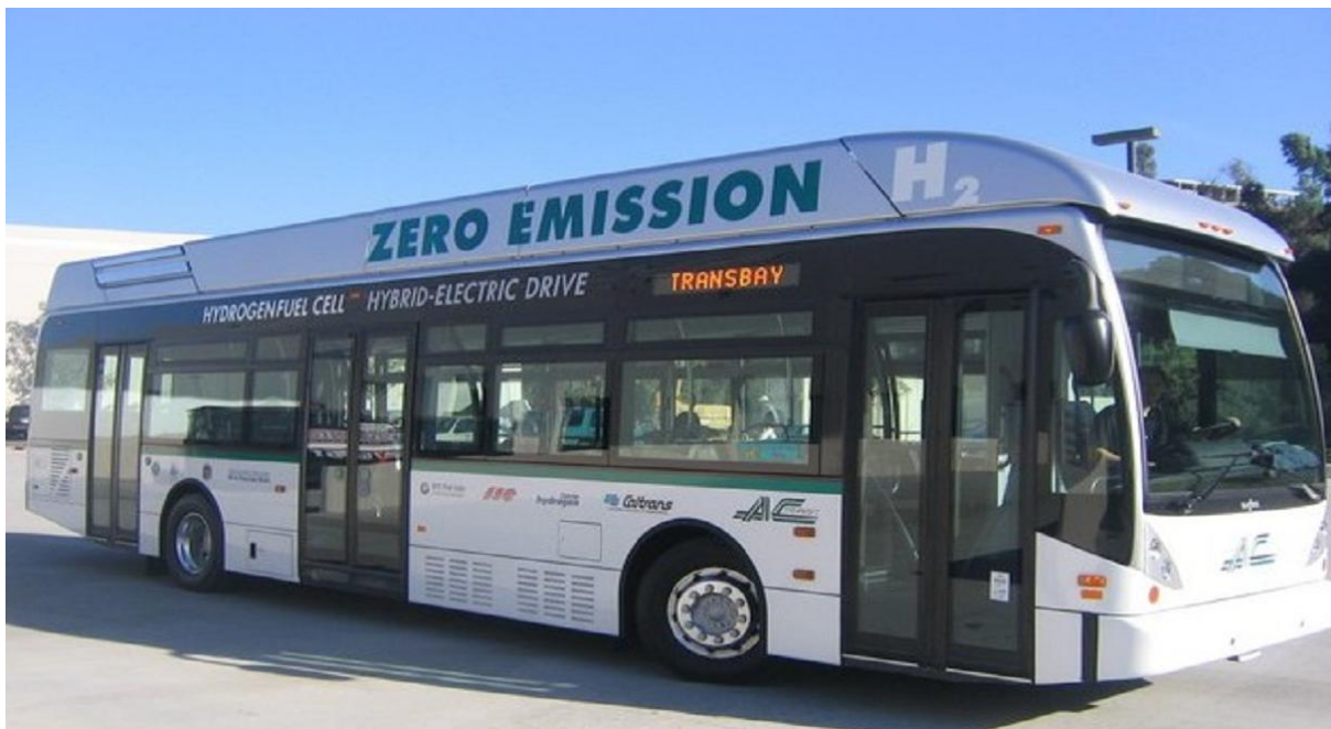
FIGURA 8 - Célula a combustível do tipo PEMFC em veículos. Fonte: If you're going to San Francisco (2009).
