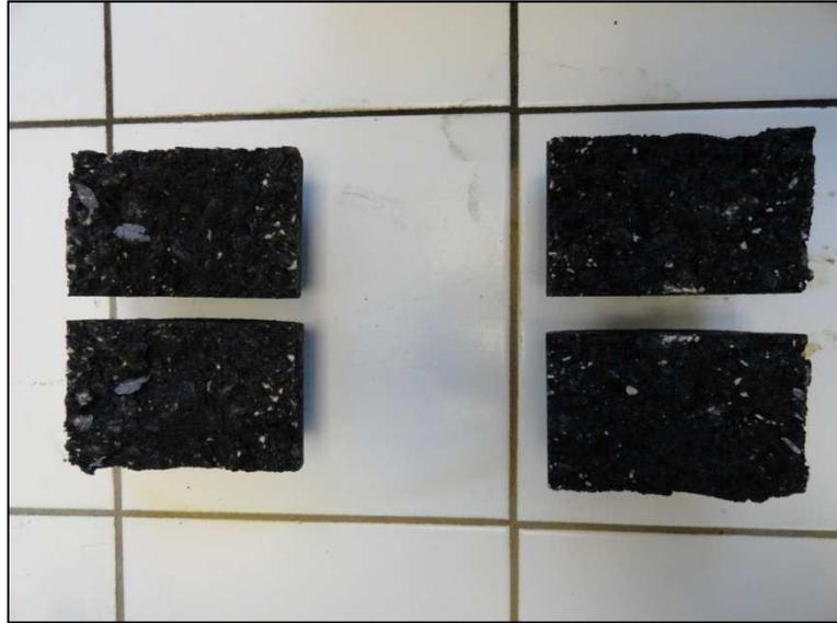
FIGURA 33: ASPECTO DO PLANO DE RUPTURA APÓS ENSAIO RRT NA MISTURA A40M100.
