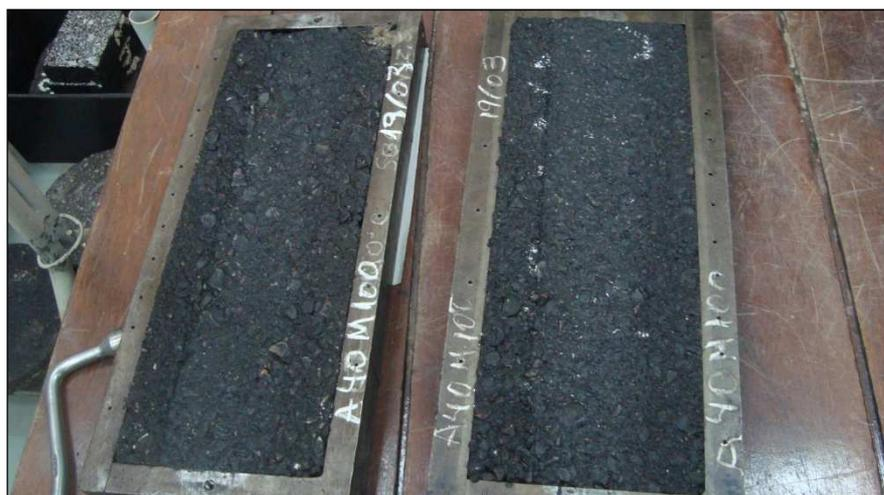
FIGURA 17: PLACAS APÓS ENSAIO NO SIMULADOR.
