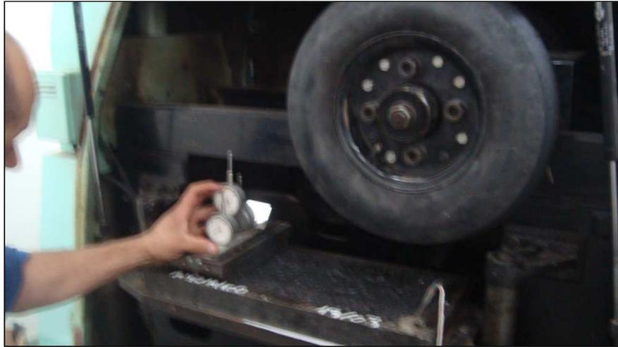
FIGURA 16: SIMULADOR DE TRÁFEGO TIPO LP.
