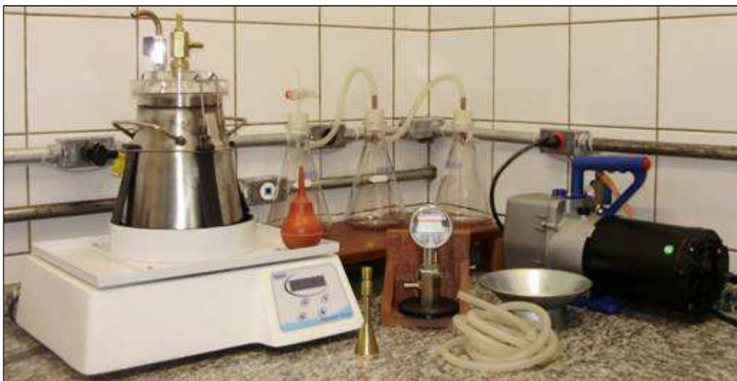
FIGURA 10: EQUIPAMENTO RICE TEST.
