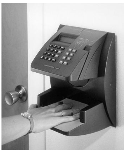
Figura 72 – Dispositivo de autenticação biométrica pela geometria da mão Fonte: ZUNKEL, 1999.
