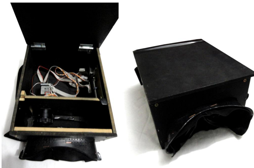
Figura 75 – Pupilômetro usado para captura dos dados Fonte: elaborado pelo autor.
