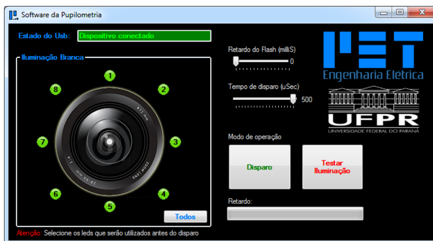
Figura 79 – Software de controle do pupilômetro Fonte: elaborado pelo autor.
