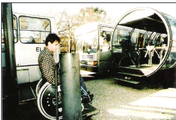
Foto 7 – Usuário utilizando elevador em estação tubo
