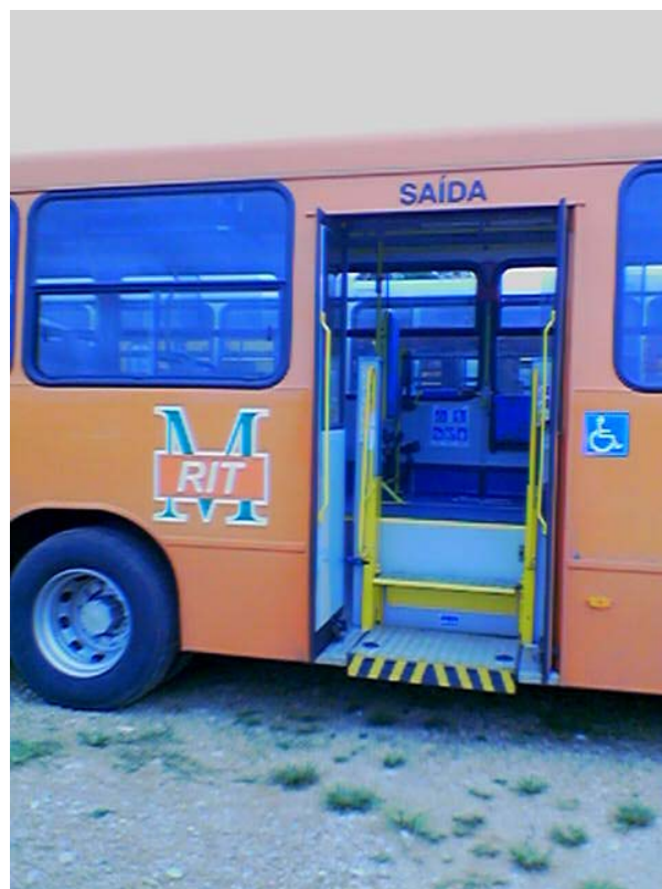
Foto 10 – Detalhe da plataforma elevatória em ônibus urbano
