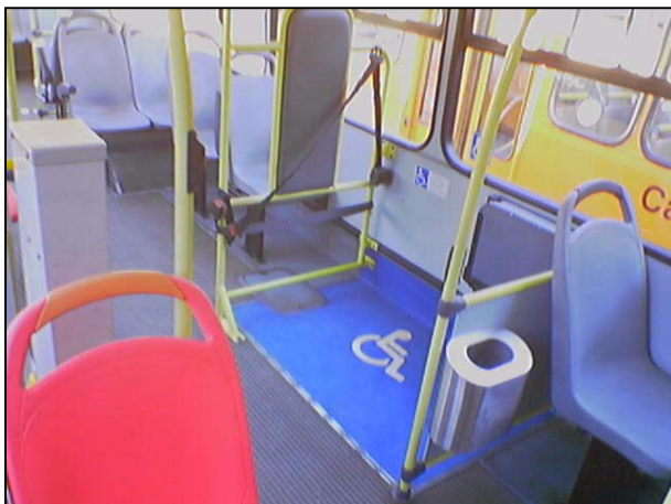
Foto 5 – Detalhe da área para o cadeirante no interior do ônibus
