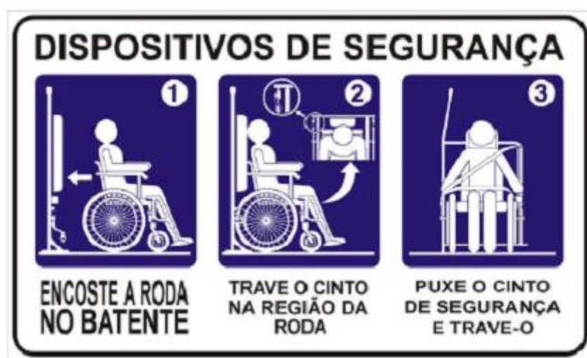
FIGURA 2.12 - ADESIVO COM INSTRUÇÕES PARA USO DA TRAVA FONTE: Norma ABNT NBR 14022:2006
