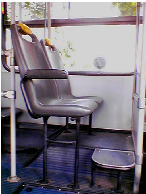
Foto 13 – Detalhe do banco reservado sobre a caixa de roda do ônibus
