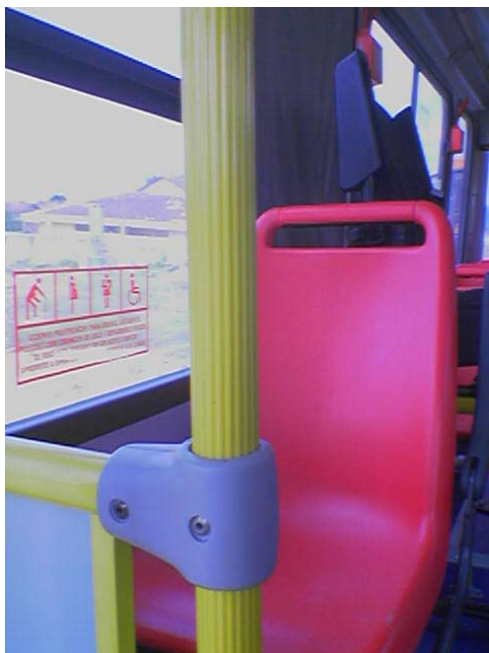
Foto 9 – Detalhe de balaústre encapsulado tátil para deficientes visuais
