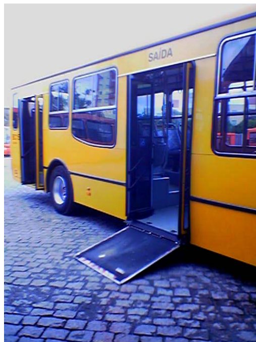
Foto 2 – Detalhe da rampa retrátil em ônibus de piso baixo
