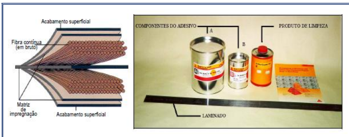
FIGURA 9 - COMPONENTES DE UM REFORÇO PRÉ-FABRICADO.
