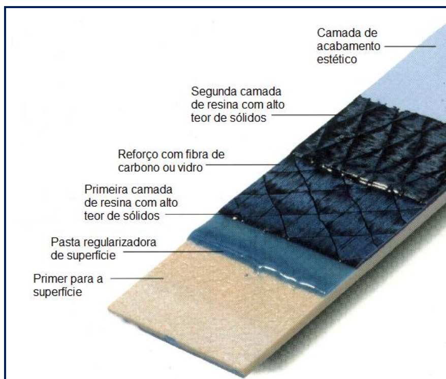
FIGURA 10 - REFORÇO COM FIBRAS DE CARBONO IN SITU .
