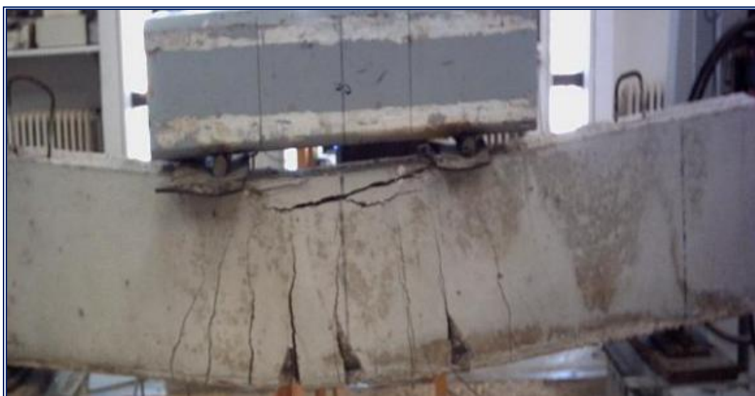
FIGURA 39 - MODO DE RUPTURA DA VIGA SEM REFORÇO DE OBAIDAT (2007). (OBAIDAT, 2007)
