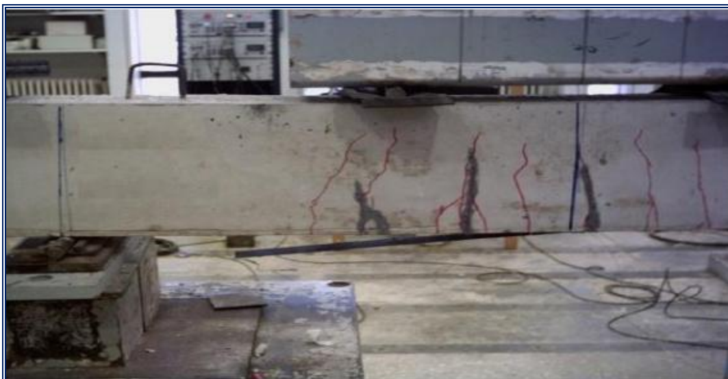
FIGURA 40 - MODO DE RUPTURA DA VIGA COM REFORÇO DE OB Aidat (2007). (OB Aidat, 2007)
