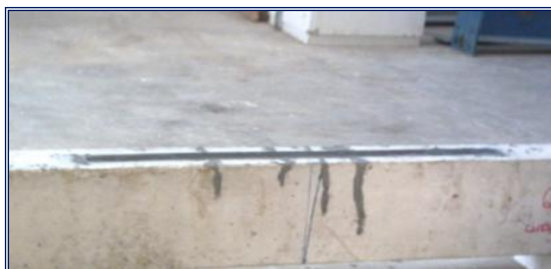
FIGURA 56 - REFORÇO DE PRFC ADERIDO EXTERNAMENTE DO ENSAIO DE OBAIDAT (2007). (OBAIDAT, 2007)
