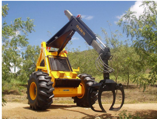
FIGURA 12: CARREGADOR FLORESTAL MODELO IMPLANOR CF 2.20
