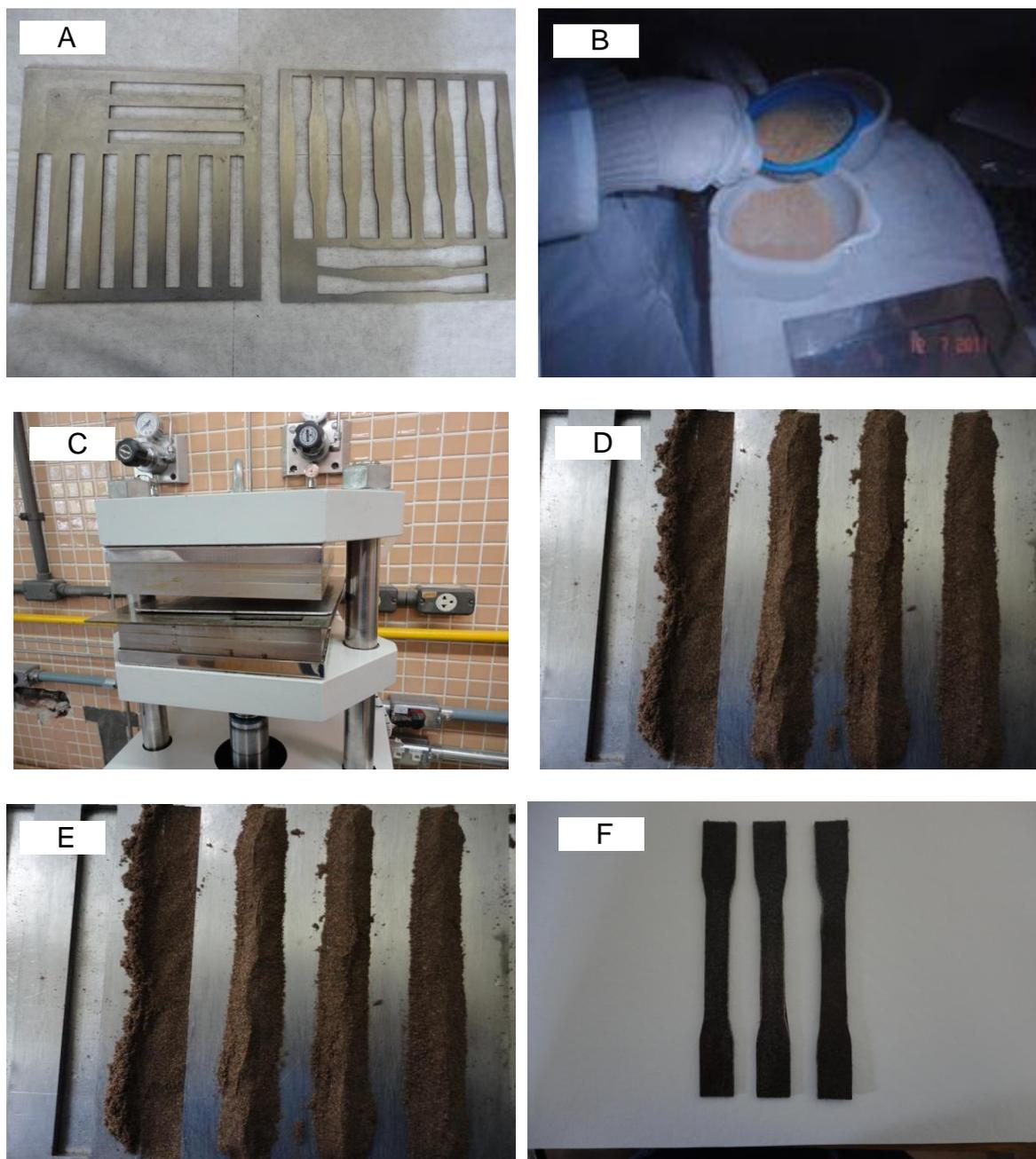
**FIGURA 7 – MOLDES METÁLICOS E PROCESSO DE PRODUÇÃO DOS COMPÓSITOS.**
