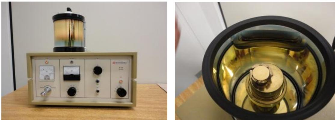
FIGURA 9- PREPARAÇÃO DAS AMOSTRAS PARA ANÁLISES DE SUPERFÍCIE (MEV) NA REGIÃO DE FRATURA
