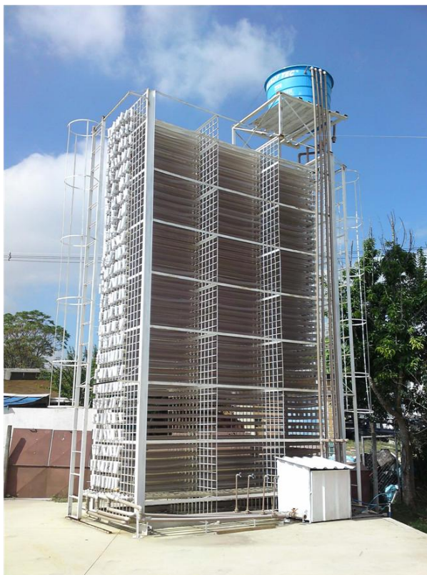
FIGURA 4.4 – FOTOBIORREATOR N° 1 DESENVOLVIDO PELO NPDEAS-UFPR-CURITIBA-BRASIL FONTE: O AUTOR (2011)
