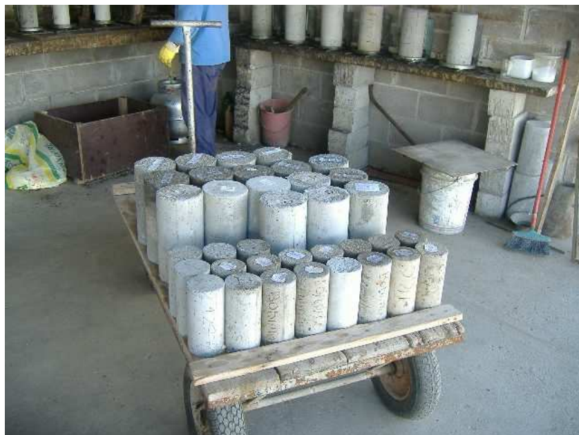
Figura 17 – Imagem de corpos-de-prova coletados para ensaio de determinação de fck. Colégio Morozovisk – Paranaguá.
