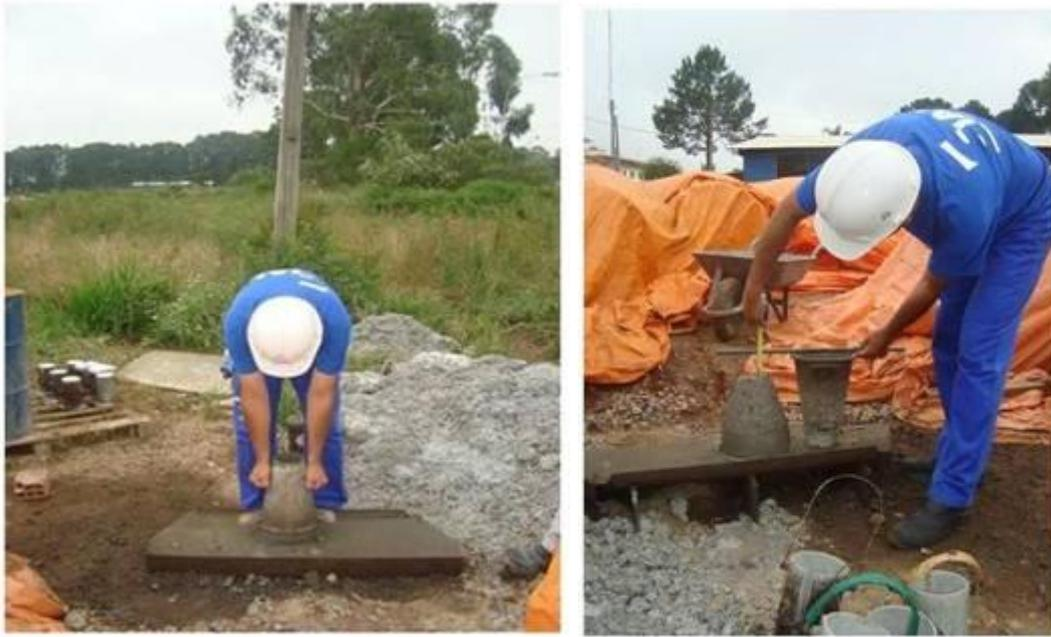
Foto 4.1 e 4.2 – Slump-Test sendo realizado com concreto de 30 Mpa
