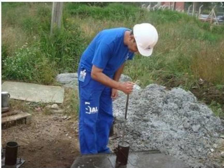
Foto 4.3 – Corpo de prova sendo moldado com concreto de 30 MPa
