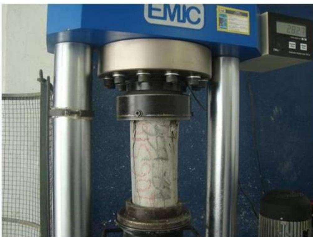
Foto 4.5 – amostragem do rompimento do Corpo de Prova de 30 Mpa
