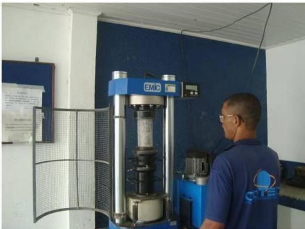
Foto 4.4 – Rompimento do Corpo de Prova de 30 Mpa para 14 dias
