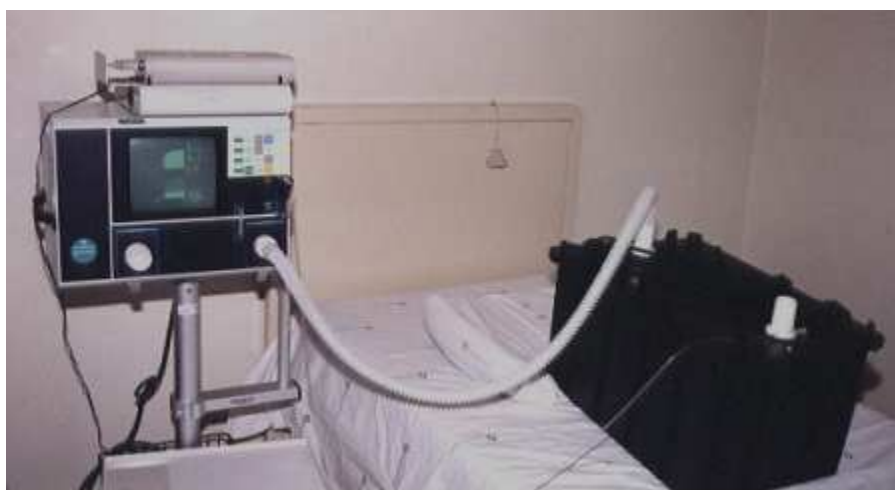
Figura 3 - Caixa para medição do consumo de oxigênio e produção de dióxido de carbono, acoplada ao monitor metabólico Deltatrac ® II (Datex).
