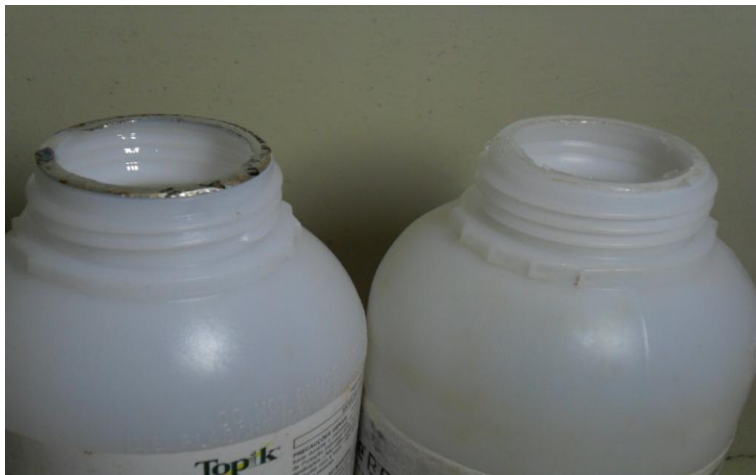
Figura 3- Embalagens COEX (esquerda) e PEAD (direita). Fonte: o próprio autor.
