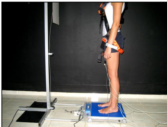
Figura 18: Acoplamento do baropodômetro eletrônico à plataforma móvel.
