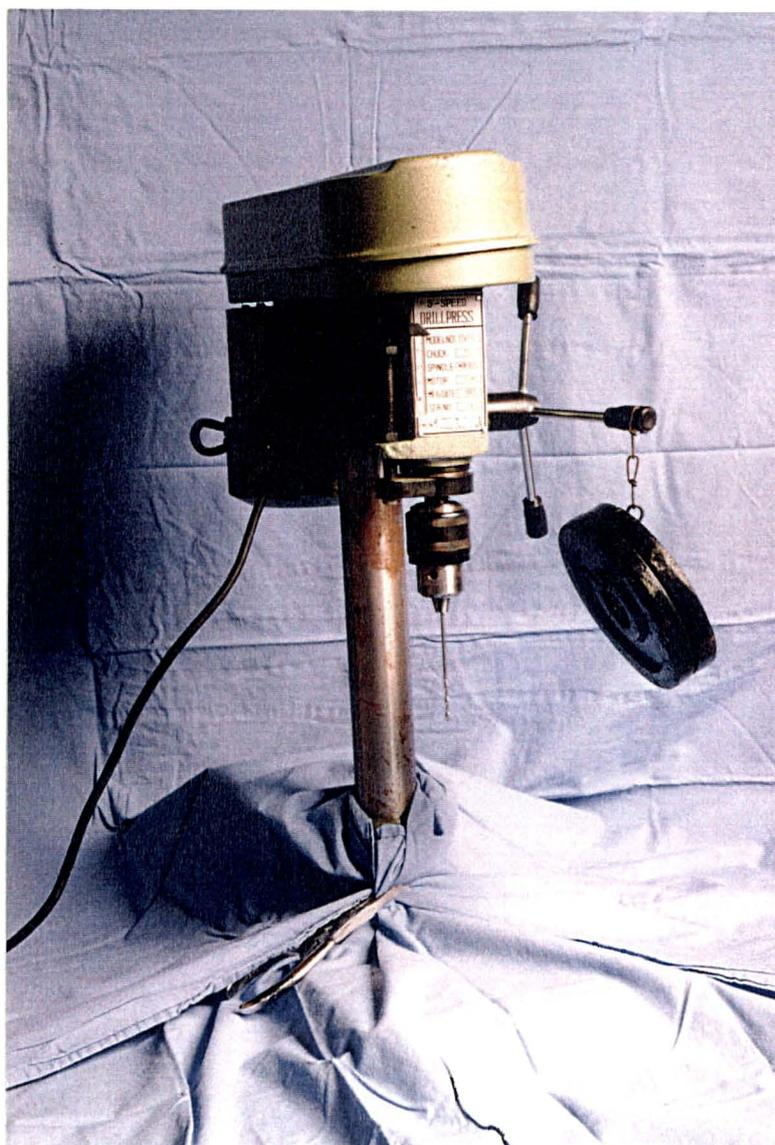
**FIGURA 3:** Perfurador elétrico de bancada com o peso de 2 quilogramas.
