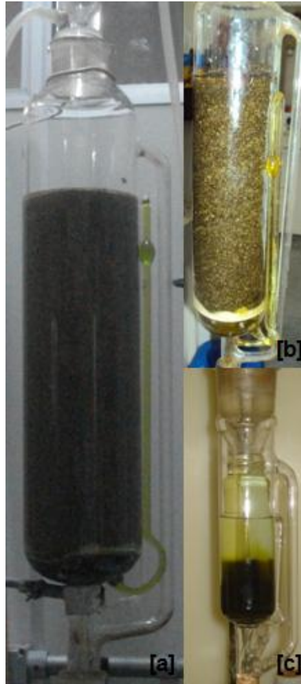
Figura 10 - Obtenção dos extratos e frações em extrator de soxhlet
