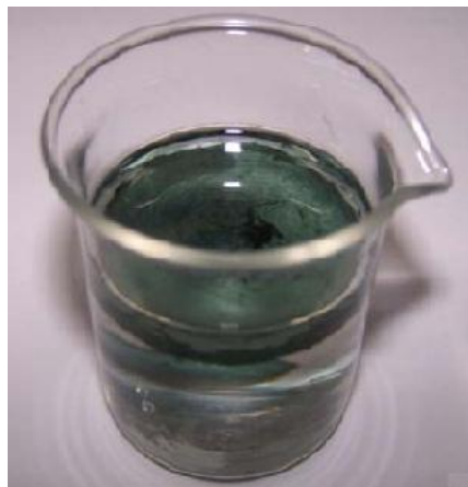
Figura 12: Béquer com filme de polianilina formado na interface água/tolueno [24].
