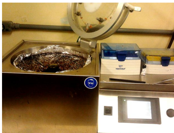
Figura 24: Spin Coater . Equipamento para aplicação de filme líquido sobre o substrato por deposição e centrifugação.
