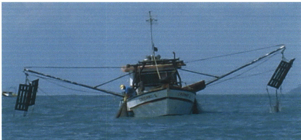
FIGURA 6 - FOTO DA TRAIINEIRA, MOSTRANDO AS DUAS REDES ACOPLADAS AO EQUIPAMENTO DE TRAÇÃO (TANGONES E GUINCHO).
