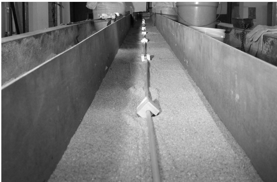
FIGURA 3.22. INSTALAÇÃO DO CABO DE FIBRA ÓPTICA NO TESTE DE ARRANCAMENTO
