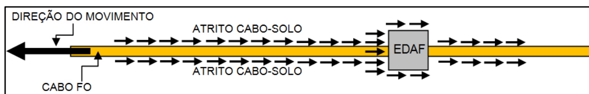
FIGURA 4.13. INTERAÇÃO CABO-SOLO NOS TESTES DE ARRANCAMENTO
