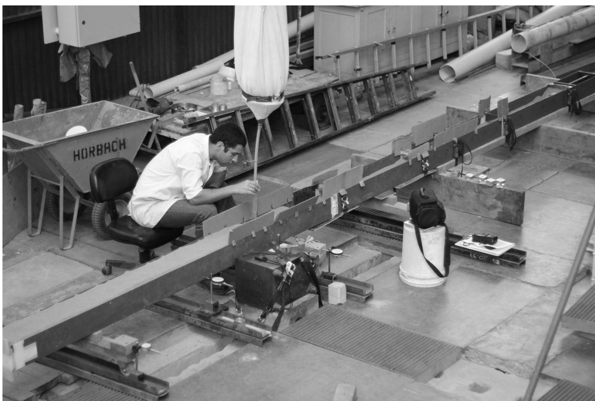
FIGURA 3.25. PREENCHIMENTO DA CAIXA DE CISALHAMENTO PELO MÉTODO DA CHUVA DE AREIA
