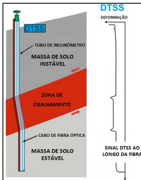
FIGURA 2.40. CONFIGURAÇÃO DA FIBRA PARA DETECÇÃO DE MOVIMENTOS DE SUBSUPERFÍCIES (HOEPFFNER ET AL., 2008)
