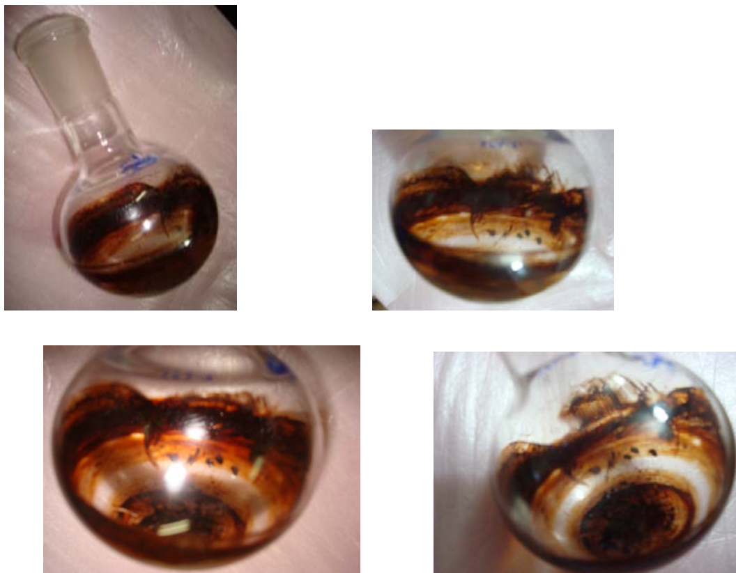
Figura 43: Imagens ao final da reação de transesterificação, fase glicérica e catalisador.
