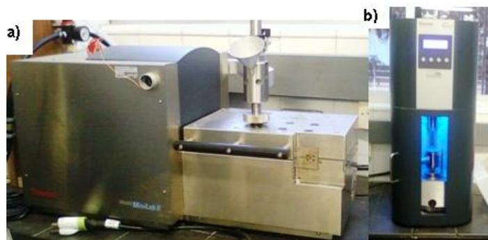
FIGURA 9: FOTOS DA MICROEXTRUSORA a) E MICROINJETORA b) UTILIZADOS NA PREPARAÇÃO DOS CORPOS DE PROVA.
