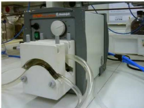
Fotografia 5 - Bomba peristáltica utilizada nos testes
