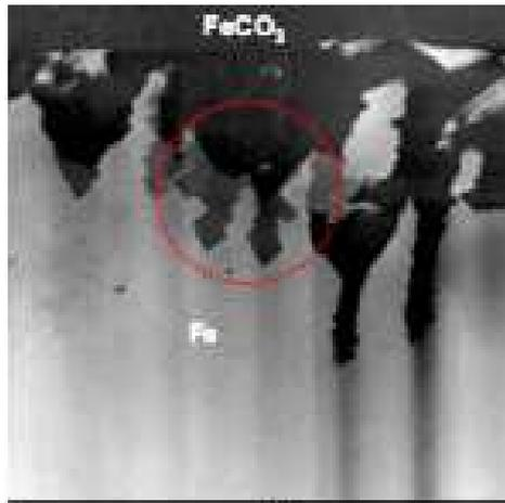
Figura 26 – Filme poroso de  $\text{FeCO}_3$  com zonas de estação de bicarbonato de sódio saturado com  $\text{CO}_2$  (NESIC, 2011).
