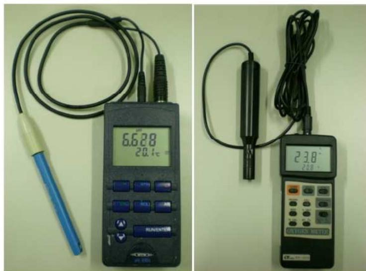
Fotografia 2 - pHmetro e oxímetro utilizados no experimento.
