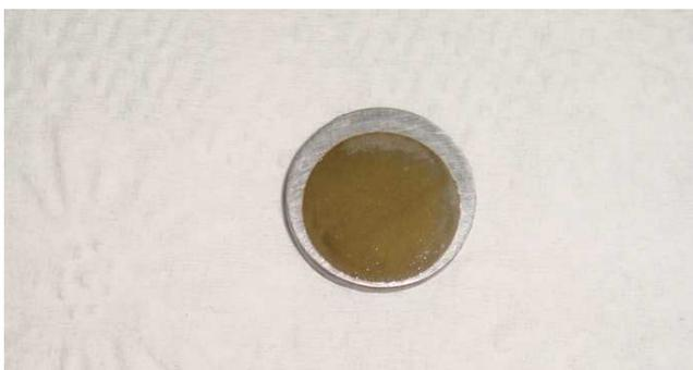
Fotografia 8 – Eletrodo de trabalho após aquisição de dados – recoberto por um filme
