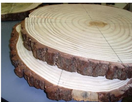
FIGURA 5 - ANÉIS DE CRESCIMENTO E MARCAÇÃO DOS RAIOS
