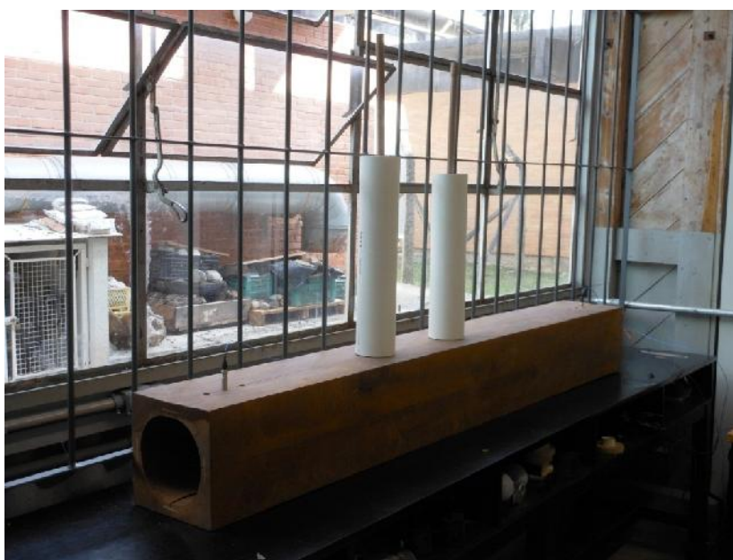
Figura 54 – Os dois ressonadores de Helmholtz acoplados à cavidade acústica.
