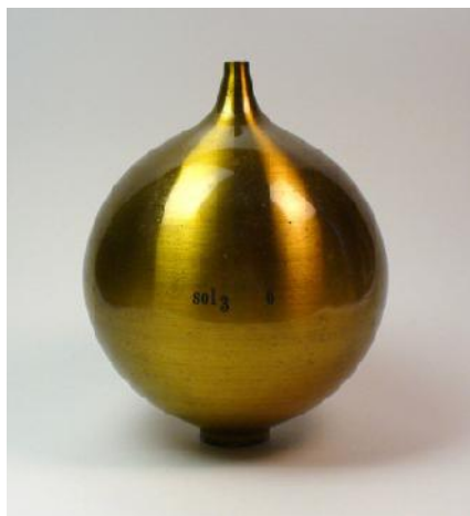
Figura 5 – Ressonador de Helmholtz (ACÚSTICA JEZABEL, 2008).
