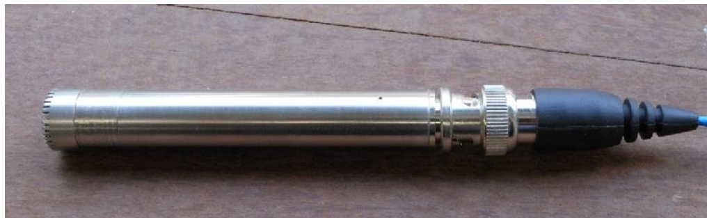
Figura 38 – Microfone utilizado na entrada da cavidade nas medições experimentais.
