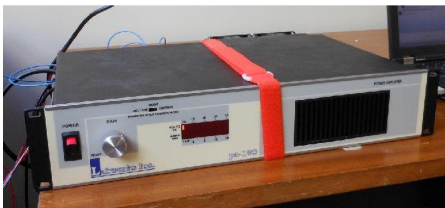
Figura 40 – Amplificador de potência utilizado nas medições experimentais.
