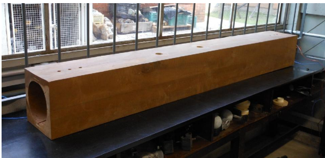
Figura 35 – Cavidade acústica utilizada nas medições experimentais.
