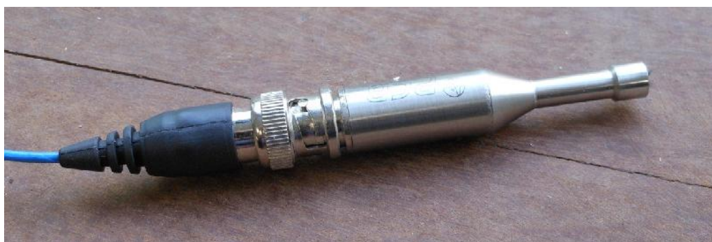
Figura 39 – Microfone utilizado na saída da cavidade nas medições experimentais.
