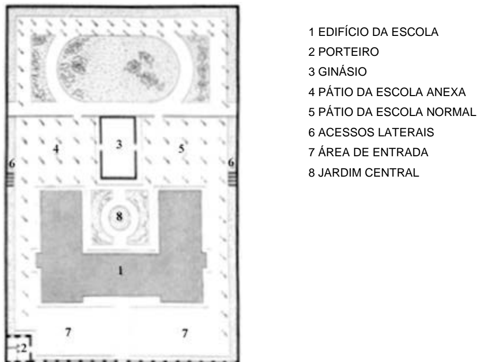
FIGURA 40 - IMPLANTAÇÃO DA ESCOLA NORMAL DE PROFESSORAS DE MELUN FONTE: ARCHITECTURE COMMUNALE, 1880, P. LXVII.
