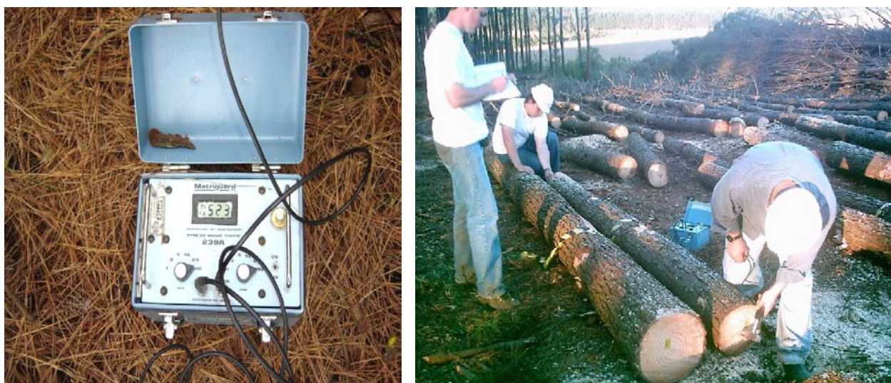
FIGURA 21– MEDIÇÃO DA VELOCIDADE DE PROPAGAÇÃO DAS ONDAS DE TENSÃO NAS TORAS E APARELHO UTILIZADO.
