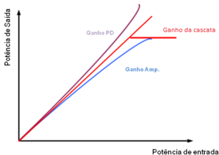
FIGURA 4 – FUNCIONAMENTO DE UM DPD IDEAL FONTE : Wood (2010)
