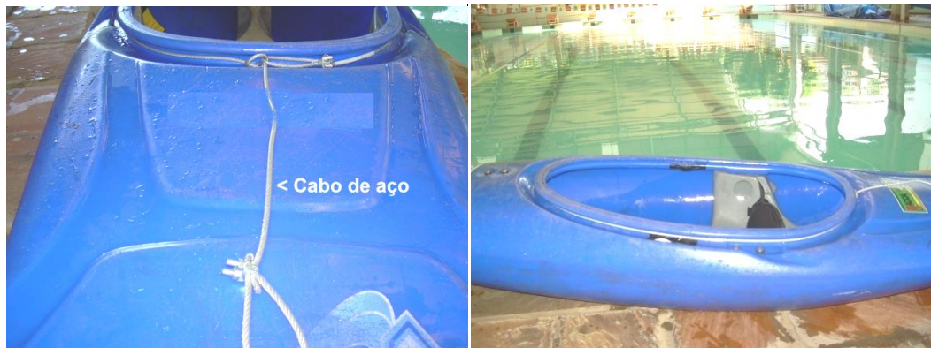
FIGURA 4.6 – FIXAÇÃO DOS CABOS NO BARCO. Fonte: autor da Tese.
