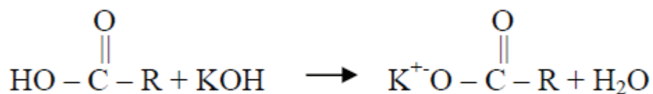
Figura 2.5 – Reação de saponificação entre o ácido carboxílico e o hidróxido de potássio.
