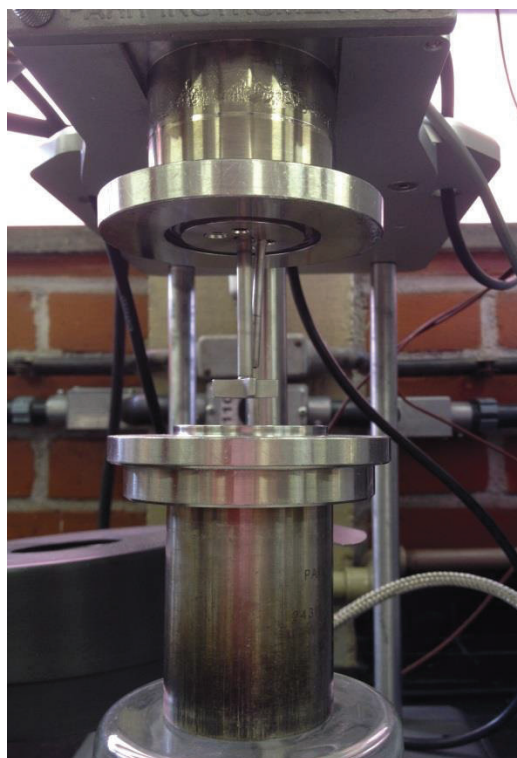
Figura 4.3 – Vaso do reator em aço inox com capacidade de 50 mL.
