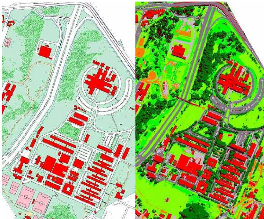
FIGURA 5.21 – COMPARAÇÃO ENTRE A INTERPRETAÇÃO VISUAL (ESQUERDA) E A IMAGEM CLASSIFICADA COM O SISTEMA COM BASE EM REGRAS (DIREITA).
