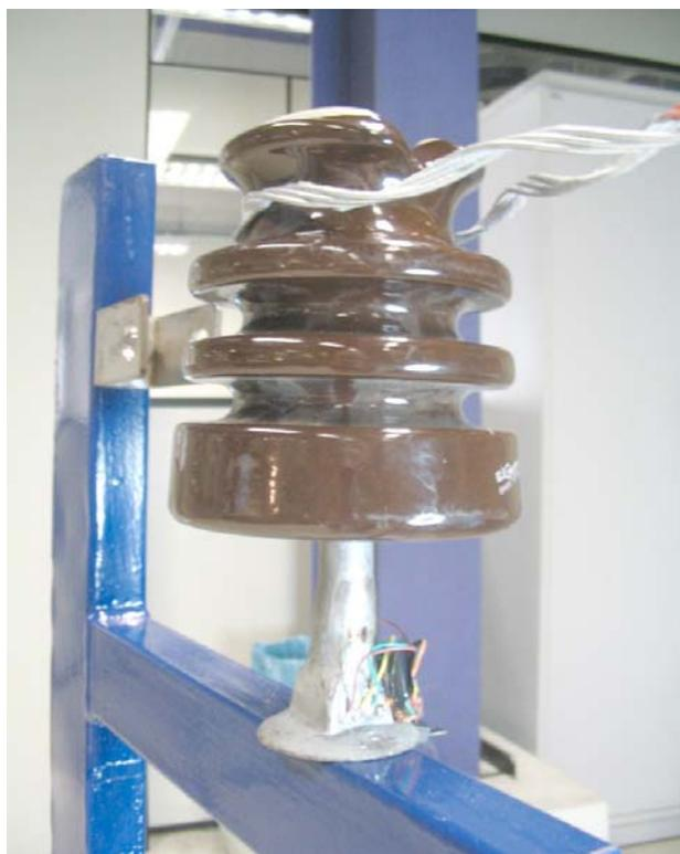
FIGURA 60 - FOTO DO PROTÓTIPO PARA O SISTEMA DE RECEPÇÃO POR RÁDIO INSTALADO NA BANCADA DE LABORATÓRIO.
