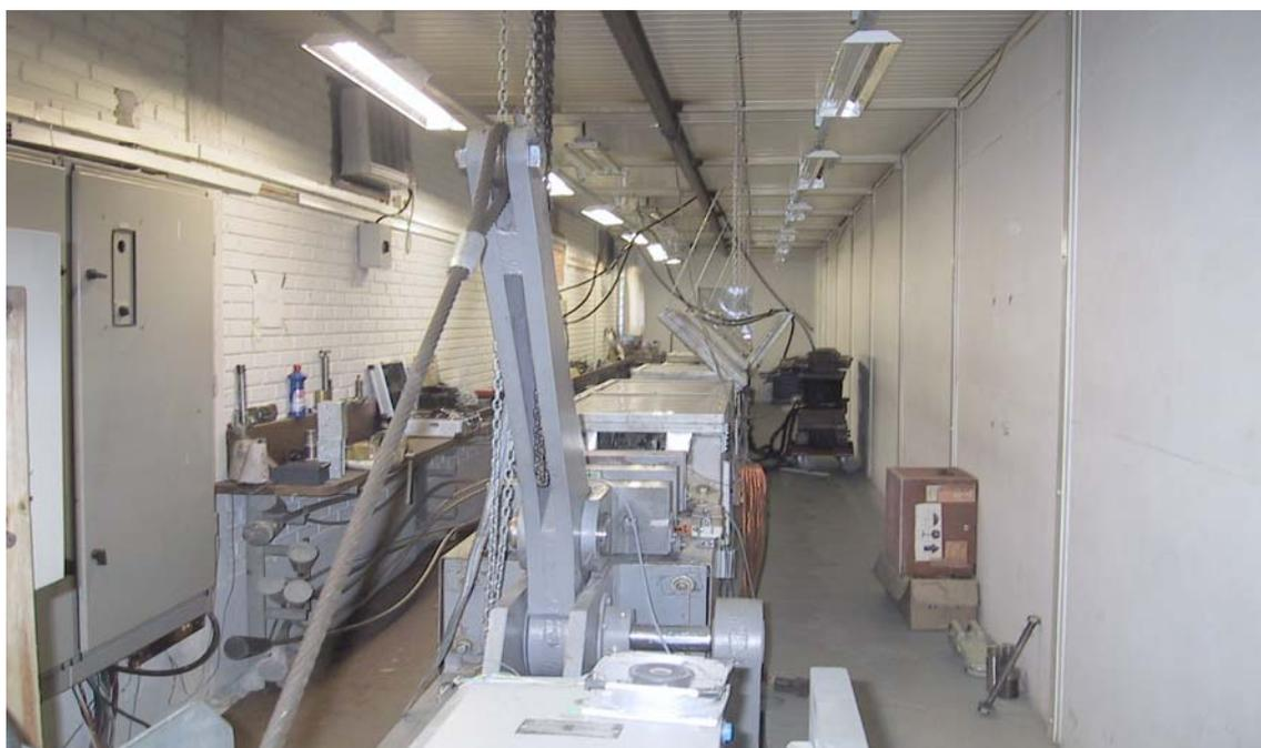
Os cabos, de 12m de comprimento, foram fixados nas duas extremidades, aplicando-se uma carga de 1,41 kN, correspondendo a 25% da carga nominal de ruptura que é de 5,64 kN [39]. A carga aplicada a um cabo em uma linha de distribuição é, usualmente, de 10 a 15% do valor nominal.
