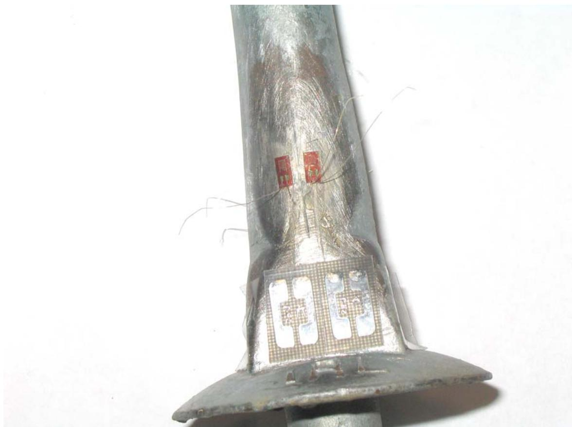
FIGURA 43 - FORMA DE LIGAÇÃO ELÉTRICA ADOTADA. QUATRO EXTENSÔMETROS LIGADOS, CONSTITUINDO CADA UM DELES UM BRAÇO DA PONTE DE WHEATSTONE [57]
