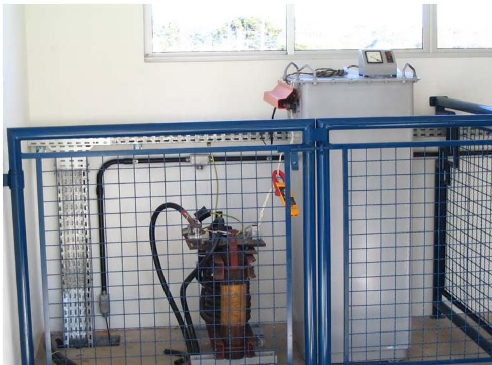
FIGURA 20 - FOTO DO DIVISOR CAPACITIVO APLICADO NO TESTE DO CIRCUITO DE 13 KV DO LABORATÓRIO
