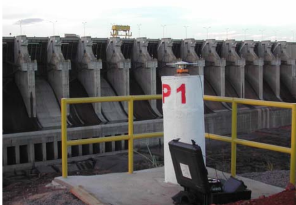
FIGURA 37 - RASTREIO GPS DO PILAR P1 – POSICIONAMENTO ESTÁTICO RELATIVO
