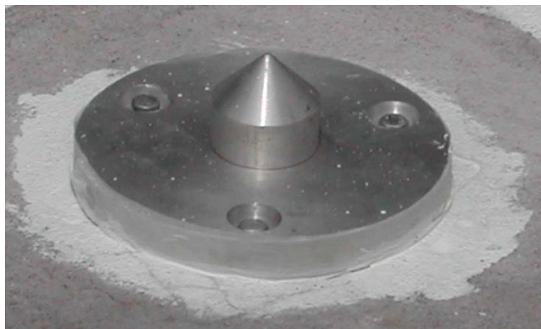
FIGURA 25 – DETALHE DO SISTEMA DE CENTRAGEM FORÇADA
