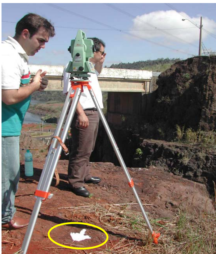
FIGURA 14 – ESTAÇÃO TOTAL ROBOTIZADA LEICA TCR705 SOBRE A POSIÇÃO DO PILAR 1
