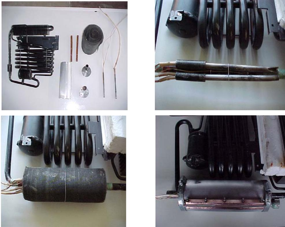
Figura. 3.3 - Componentes do Gerador
