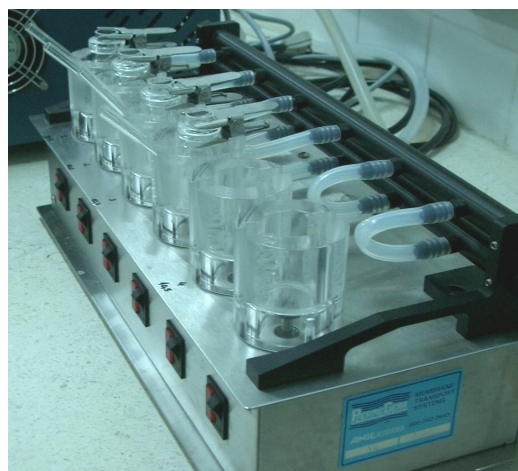
Figura 15: Equipamento Permeagear ® acoplado à banho-maria, com quatro células de difusão in vitro .
