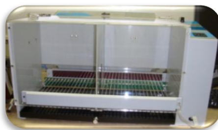
FIGURA 15: Imagem do aparato utilizado para esquiva ativa de duas vias (GEMINI Avoidance System, San Diego Instruments, San Diego, CA)
