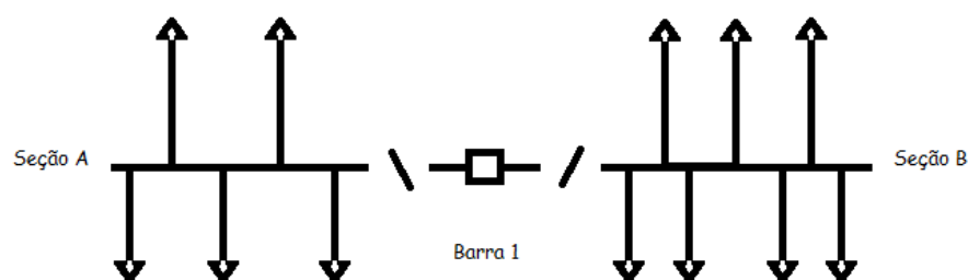
Figura 2.6 - Restrição operativa por seccionamento de barra
