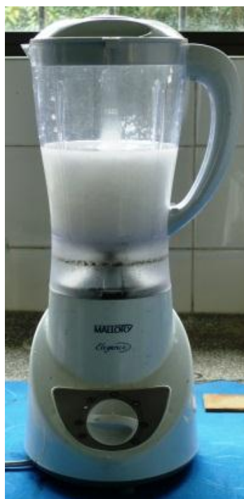
FIGURA 7 - PREPARAÇÃO DA POLPA CELULÓSICA PARA OBTENÇÃO DAS MICROFIBRILAS DE CELULOSE
