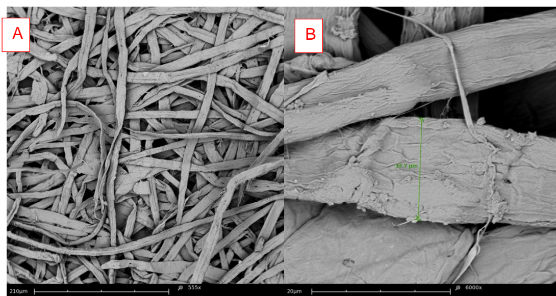
FIGURA 12 – MICROGRAFIA DAS FIBRAS DE CELULOSE - MEV
