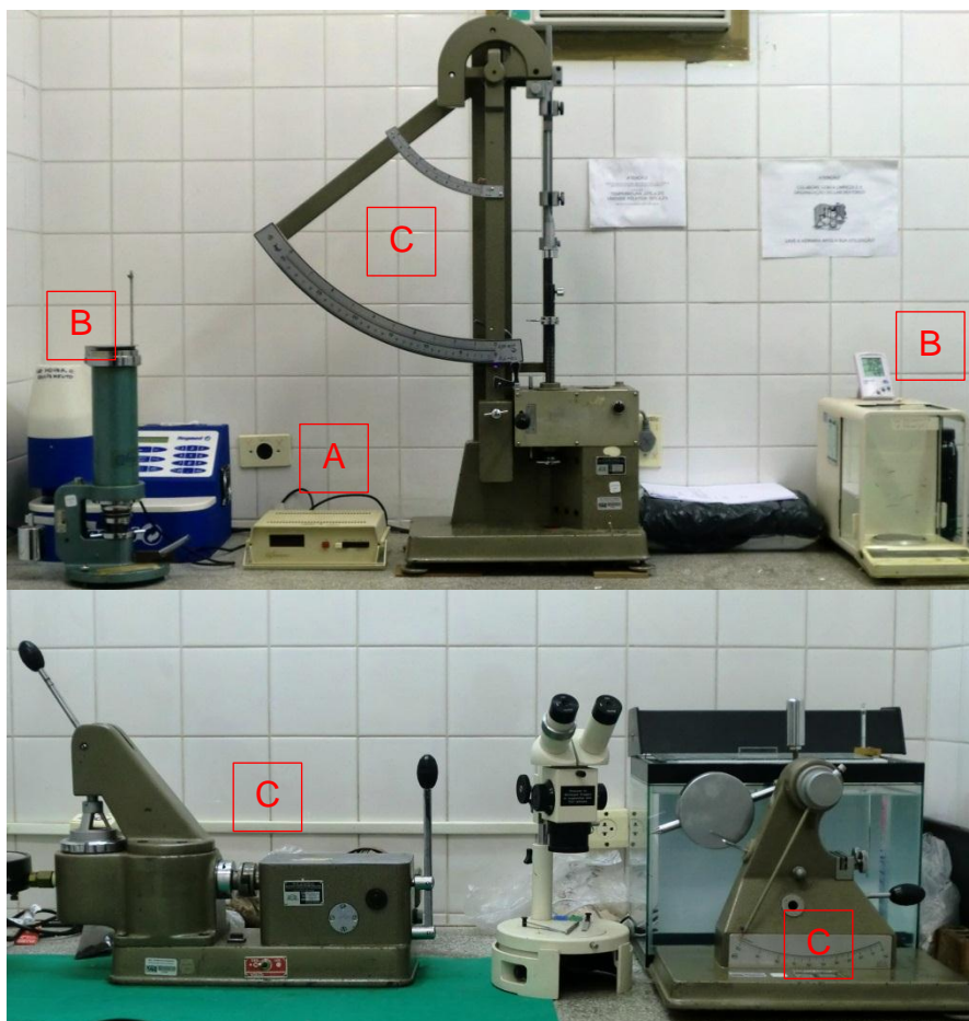
FIGURA 10 – CONJUNTO DE EQUIPAMENTOS PARA REALIZAÇÃO DE ENSAIOS ÓPTICOS (A), FÍSICOS (B) E MECÂNICOS (C). Fonte: A autora, 2011
