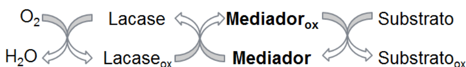
FIGURA 3 – REPRESENTAÇÃO ESQUEMÁTICA DA ATIVIDADE CATALÍTICA DE LACASE NA PRESENÇA DE MEDIADORES FONTE: O autor, 2013.
