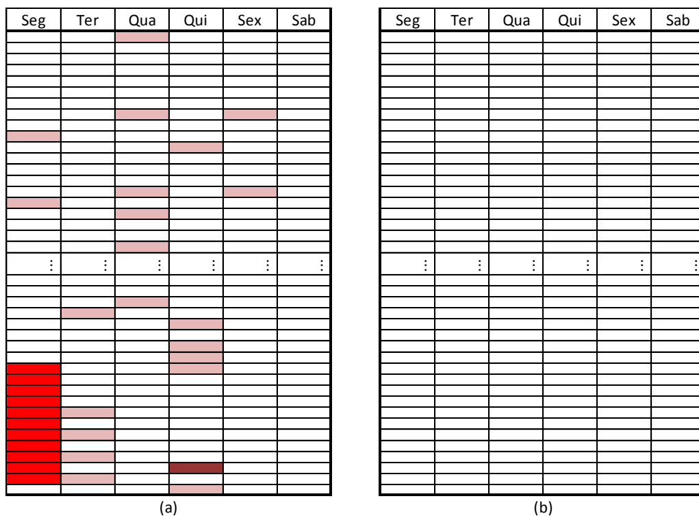
FIGURA 32 -- VEÍCULOS COM QUEBRAS DE RESTRIÇÕES DE PARTE DA SEQUÊNCIA DE PRODUÇÃO DA SEMANA 3 PARA SEQUENCIAMENTO (A) REALIZADO E (B) PROPOSTO.
