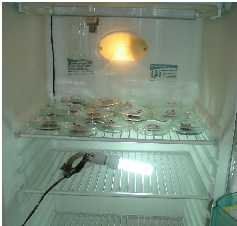
FIGURA 11 - TESTE ACONDICIONADO EM PLACAS DE PETRI E INCUBADO EM ESTUFA B.O.D. FONTE: FERNANDO KLOSTER.
